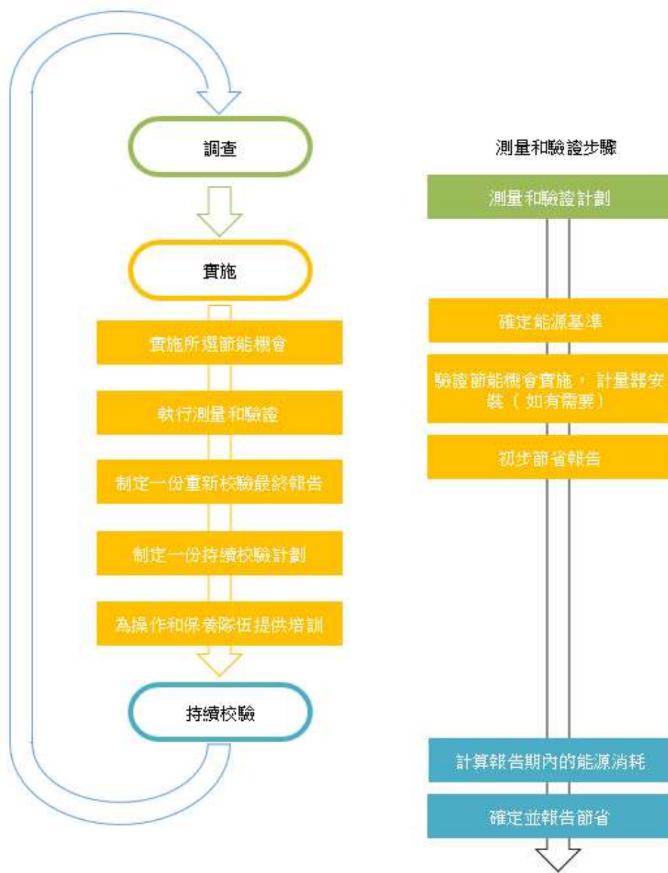
圖 4.4.2 重新校驗階段和測量和驗證步驟
